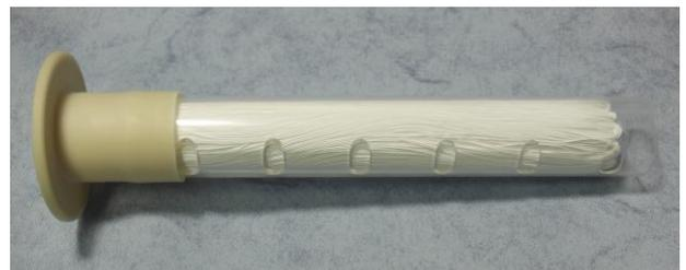
Abb. 0,1 µm Hohlfasermembrane aus PE
