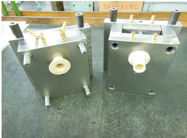
Abb. Flanschcapenproduktion mit eigenen Spritzgießwerkzeugen.
